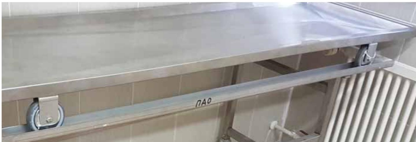
Тележка поддон для загрузки с подкатной тележки на подъемник и с подъемника на стеллаж. Материал рамы - сталь, окрашенная порошковой краской или нержавеющей сталь марки AISI 304. Ложе – НЖС. 4 колеса 50 мм или 8 колес диаметром 100 мм. Грузоподъемность - 150 или 200 кг. Размер (ДхШхВ), мм: 2000х580х120 или 2000х580х170. Вес 10 или 15 кг. Поддон совместим со стеллажами, подъемником и подкатной тележкой марки "ЛТВ". Сертификат соответствия ЕАС № ЕАЭС N RU Д-РУ.НВ29.В.07396/20.
