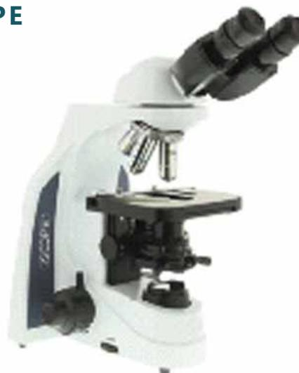
Микроскопы из серии iScore оснащены бинокулярной оптической насадкой с широкопольными окулярами, четырема планахроматическими объективами 4x, 10x, S40x, S100x (масляная иммерсия), скорректированными на бесконечность; имеет двухступенчатую фокусировку рукоятками грубой и тон-
