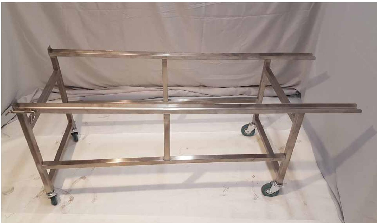
Тележка подкатная. Материал - сталь, окрашенная порошковой краской или НЖС. Рельсы из нержавеющей стали марки AISI 304, ширина рельс 550 мм. 4 колеса диаметром 125 мм. В т.ч. 2 колеса поворотные. Грузоподъемность - 150 кг или 200 кг. Размер (ДхШхВ), мм: 1600х600х700. Вес 20 кг. Тележка совместима со стеллажами, подъемником и поддоном марки "ЛТВ". Сертификат соответствия ЕАС № ЕАЭС N RU Д-РУ.НВ29.В.07396/20.
