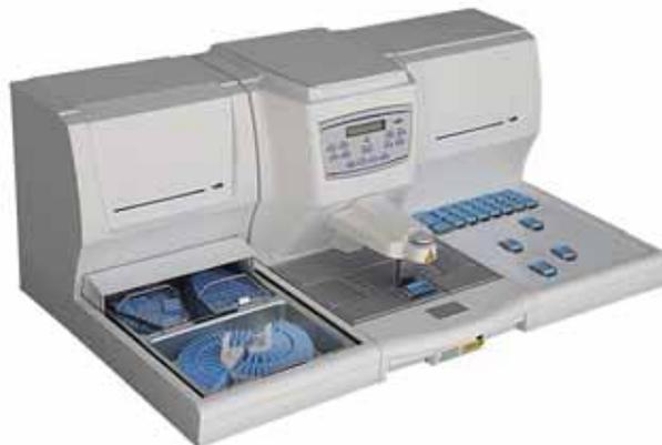
*Трехмодульная система заливки тканей в парафин: заливочный модуль, нагревательный модуль, охлаждающий модуль. Объем парафина-5литров. Модули могут работать отдельно.*
